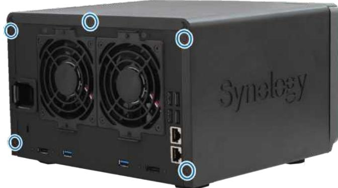
**Važno:** Kada skinite poklopac izlažete osjetljive dijelove. Pazite da ne dodirujete komponente kako bi izbjegli moguća oštecenja prilikom instaliranja i zamjene memorije.
